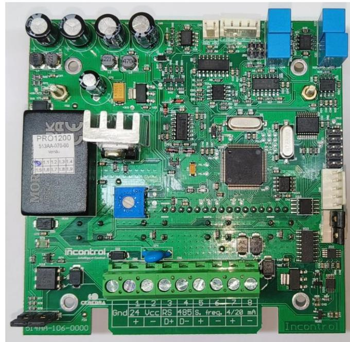
Bornes do conversor de vazão PRO1200
