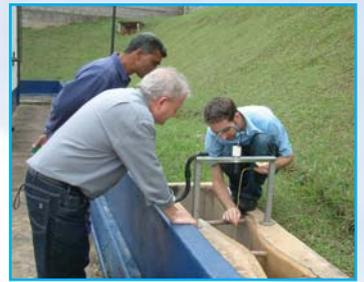
Técnico da Incontrol durante start up de sistema ultrassônico em calha Parshall
